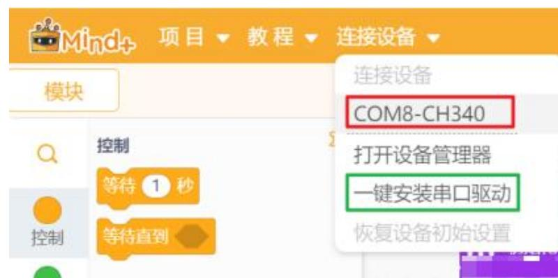
点击识别出来的串口，成功连接设备后就会显示该设备对应的串口。再点击“上传到设备”，等待上传完成。
