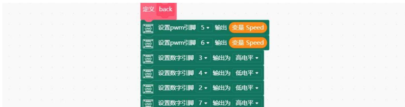
其他端口如此类推，每一个移动动作都需要控制 2 个引脚的电平和 2 个引脚 pwm 输出来实现
