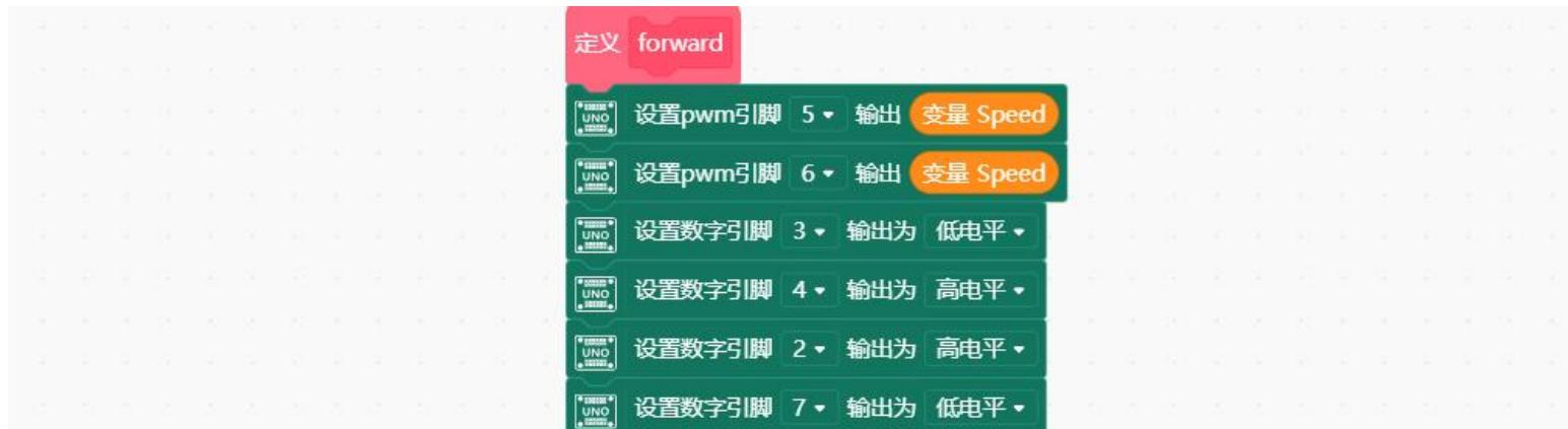
5/6 引脚 pwm 输出 “Speed” 对应的值，3/7 引脚给高电平和 4/2 引脚低电平时则控制汽车后退；
