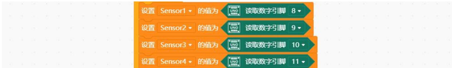
通过比较四个变量的值，根据循迹原理控制小车沿着线路中间走。
