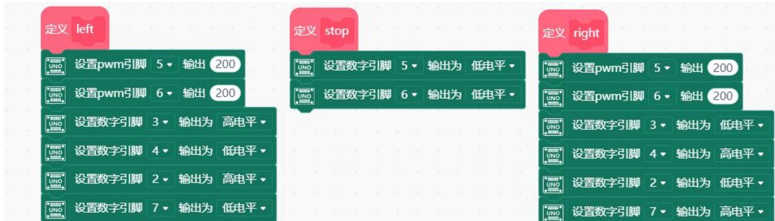
将封装好的函数放到循环中每隔 1 秒执行一次小车运动
